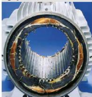
Falta de fase ligação estrela
