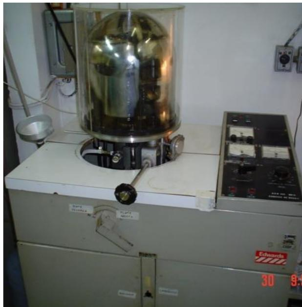
*Figura 48: Evaporadora de metais utilizado para evaporar alumínio, titânio, paládio e prata nos processos de deposição de contatos metálicos em células solares.
