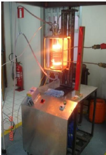
*Figura 32: Forno para solidificação unidirecional.*
