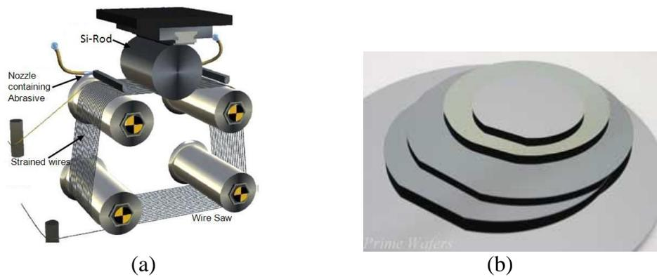
Figura 29: (a) Serra de fio diamantado para corte de lâminas de silício; (b) lâminas de silício de diferentes diâmetros.
