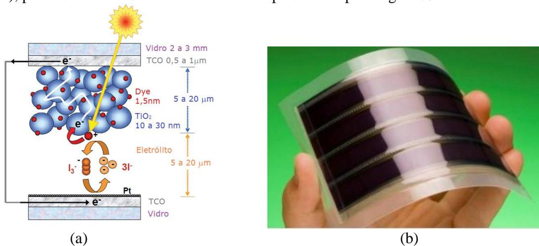
Figura 59: (a) Diagrama esquemático de uma célula solar de corante; (b) Célula solar Grätzel.
