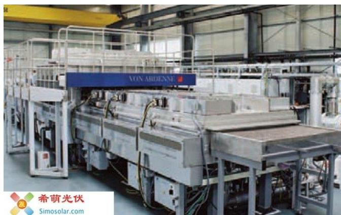
Figura 53: Sistema de sputtering industrial para metalização de contatos para células de silício amorfo.
