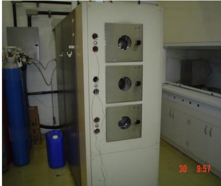
*Figura 47: Forno de difusão utilizado para dopar silício com fósforo no Laboratório de Pesquisas Fotovoltaicas (LPF) do IFGW/Unicamp
