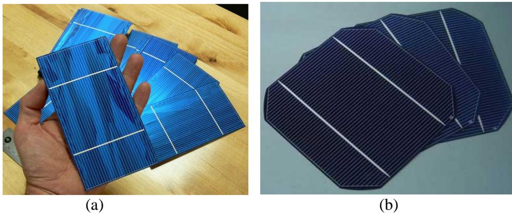
Figura 50: (a) Células solares de silício policristalino e (b) monocristalino.
