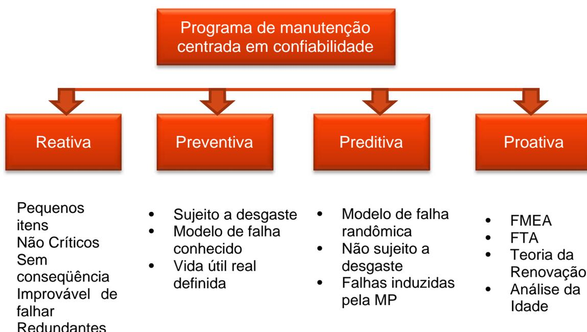
Figura 21: Principais componentes de um programa de manutenção centrada em confiabilidade
