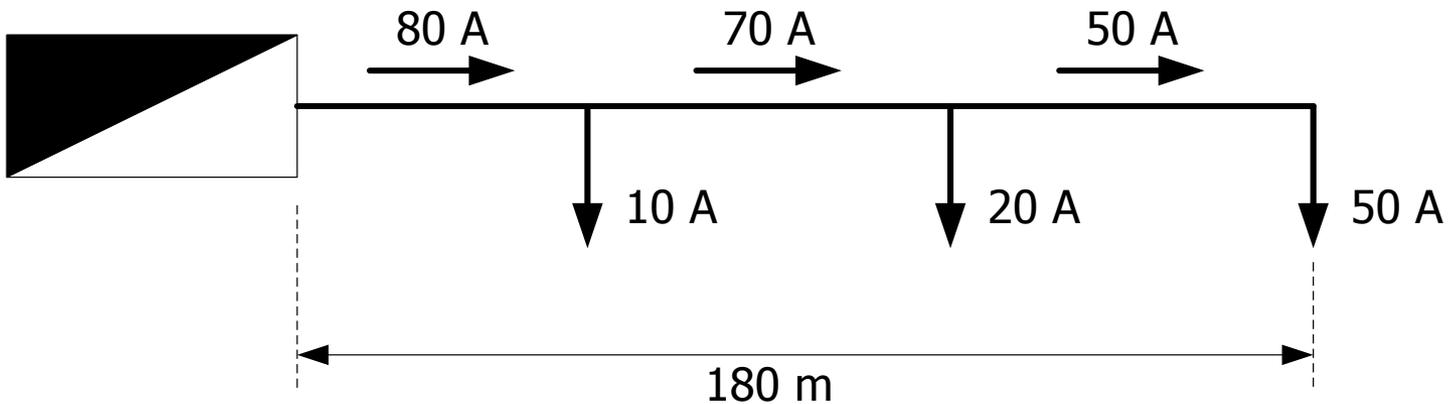
$$\rho = 0,018 (\Omega \text{ mm}^2 / \text{m}) \quad U_p = 5,5 \text{ V}$$
