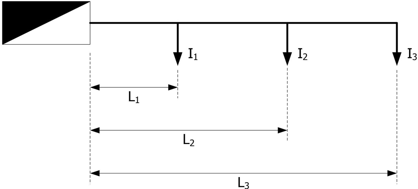
**$I_1$ ,  $I_2$ ,  $I_3$** : Corrente de cada ramal associada ao alimentador (A).
