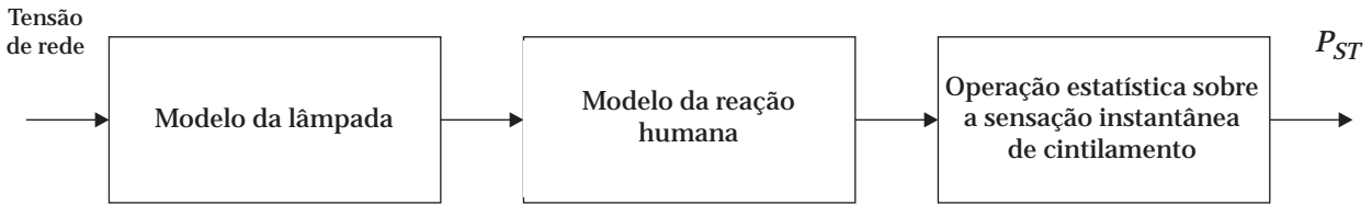
Figura 4 - Operações para determinar a severidade de cintilamento PST.
